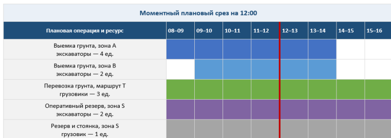
Рисунок 1: а) Диаграмма Ганта модельного примера и моментный срез на 12:00, б) ортофотоплан с векторными зонами и объектами техники
